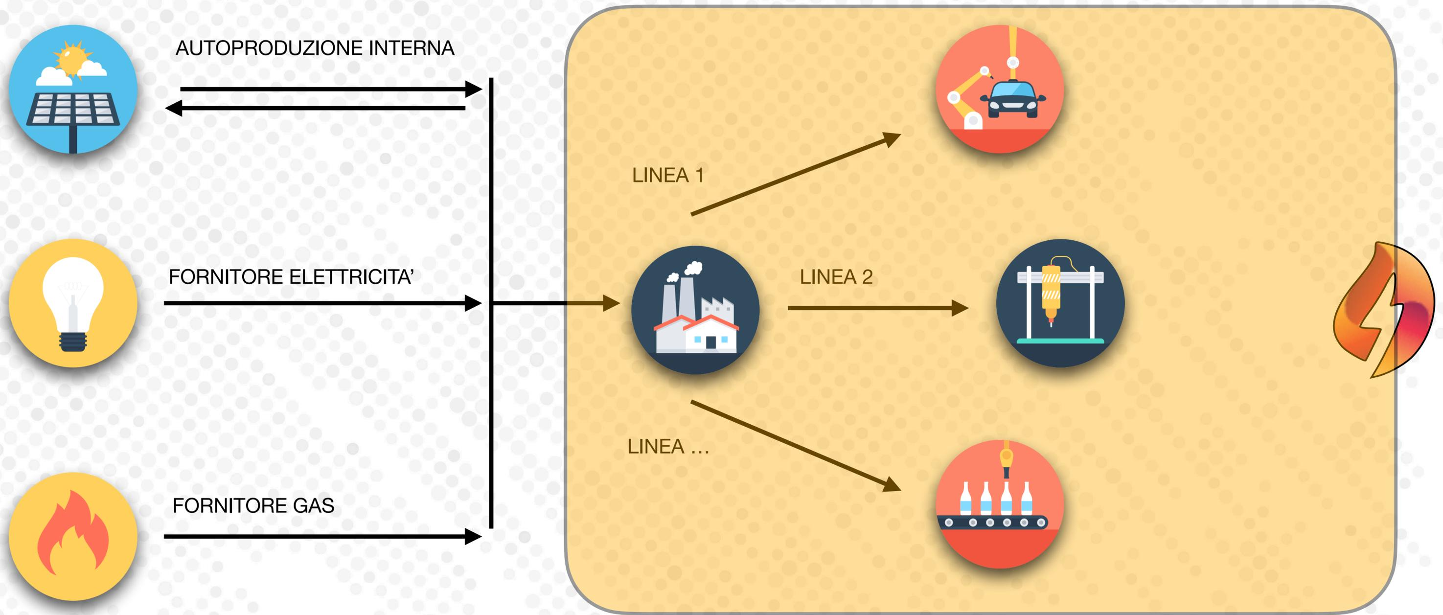
Il sistema di monitoraggio AsyTrack ENERGY-METER raccoglie i consumi rilevati dai contatori della grande distribuzione e/o dall'eventuale produzione interna e li trasmette, in tempo reale, al software che li gestirà nella maniera più consona alle esigenze dell'azienda.
